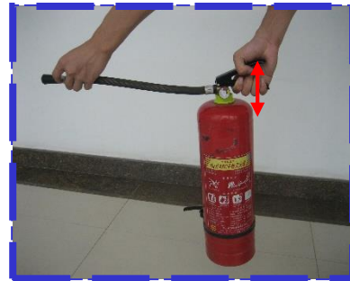
5: 选择上风向，(距火源1.5米左右) 启闭阀往下压
