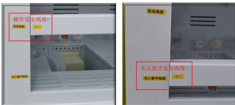
图 5 通风橱面板的规范高度
